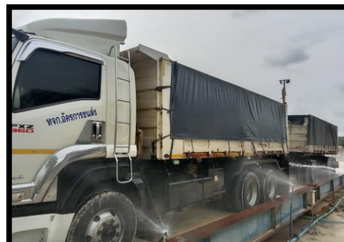
รูปที่ 2-23 ที่ล้างน้ำหนักและรถบรรทุกคลุมผ้าใบ
